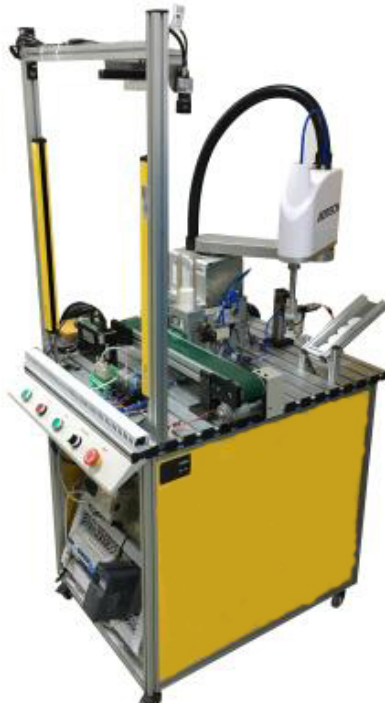
四自由度工业机器人安调维护工作站
